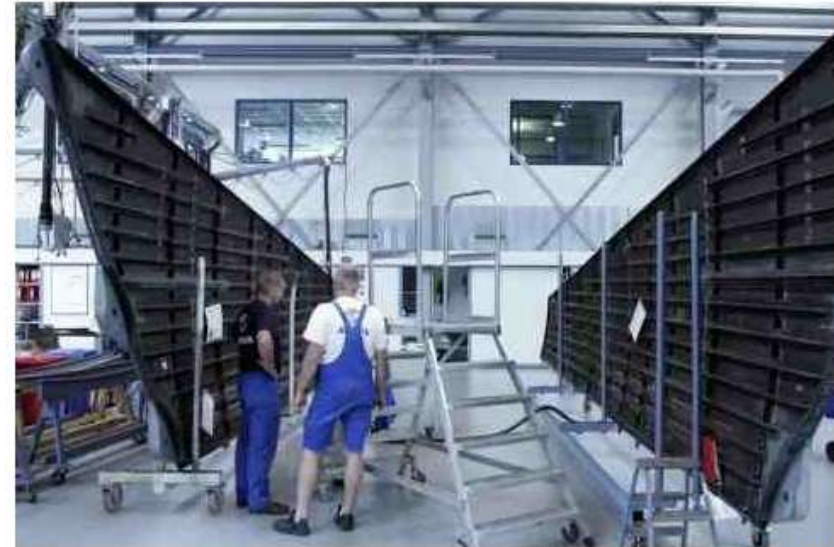
Airbus-Mitarbeiter fertigen im Werk in Stade Seitenleitwerk-Schalen aus dem neuen Material CFK, einem mit Kohlefasern verstärkten Kunststoff
